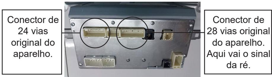
Se o pino 2 do conector 28 vias original do veículo não existir, ligue o pino 2 do conector fêmea do rádio original ao sinal de marcha ré do veículo.
